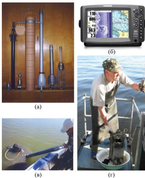
Рис. 1.21. Оборудование для регистрации и отбора проб донных отложений: а – грунтовые трубки, б – эхолот Lowrance LMS-240, в – отбор проб с помощью аквалангиста, г – отбор проб дночерпателем.
