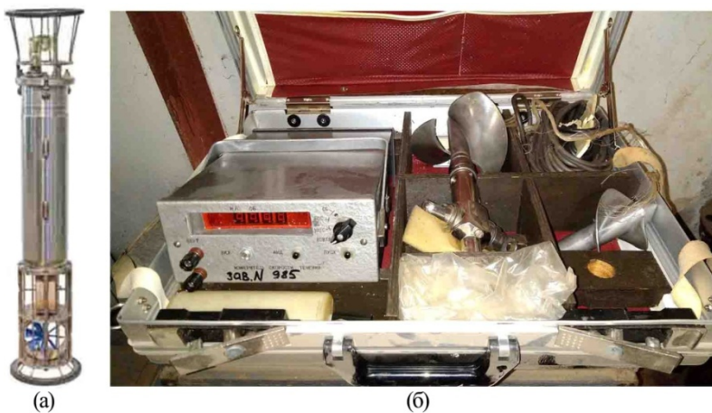
Рис. 1.17. Самописец течений АЦИТТ (а) и гидрометрическая вертушка ВГ-1-120/70 с регистратором скорости течения ИСТ 1-0.06/120/70.
