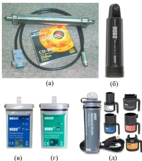
Рис. 1.6. Термокапметр разработки Института водных проблем Севера РАН (а), блок измерения температуры, электропроводности воды и давления самописца АЦИТТ (б).
