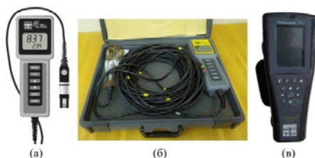
Рис. 1.7. Многопараметрические зонды: а – YSI Model 85; б – YSI Model 30M; в – YSI Pro Plus.
