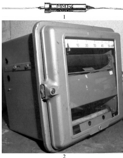
Рис. 1.5. Части комплекса для регистрации температуры воды в 1977 г. на Белом и Сиверском озерах. 1 – терморезистор ММТ-4; 2 – потенциометр ЭПП-9.
